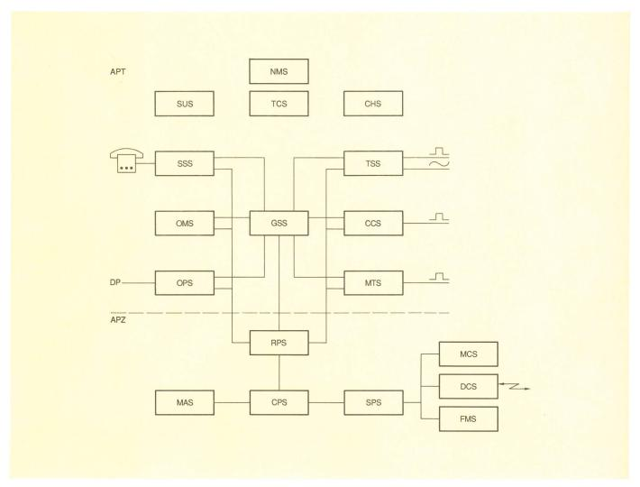
Fig. 3 Sottosistemi AXE 10
