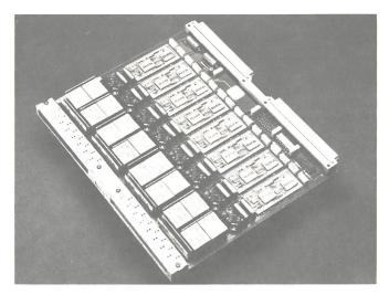
Fig. 7 Modulo di collegamento per 8 abbonati
