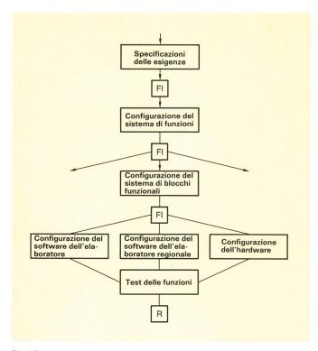
Fig. 13 Programma di sviluppo normalizzato FI Ispezione formale
