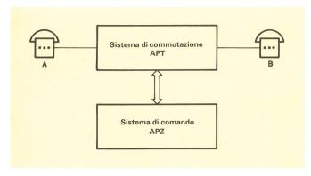
Fig. 1 Schema semplificato del sistema AXE 10
