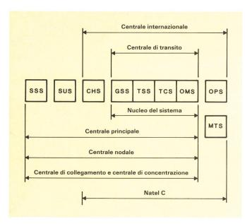
Fig. 4 I sottosistemi del sistema di commutazione
