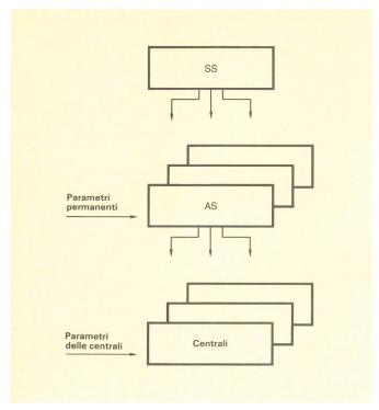
Fig. 6 Struttura della gestione AXE 10 AS Sistema applicativo
