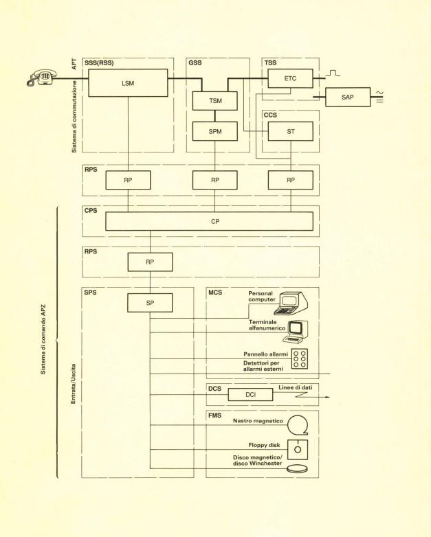
Fig. 5 Struttura dell'hardware AXE 10
