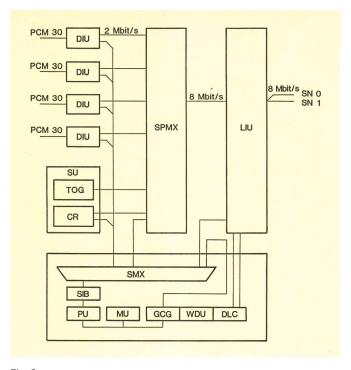
Fig. 3 Schema a blocchi di un gruppo di raccordo LTG (esempio LTGC)
