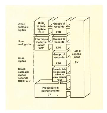
Fig. 2 Struttura EWSD in ambiente analogico/digitale
