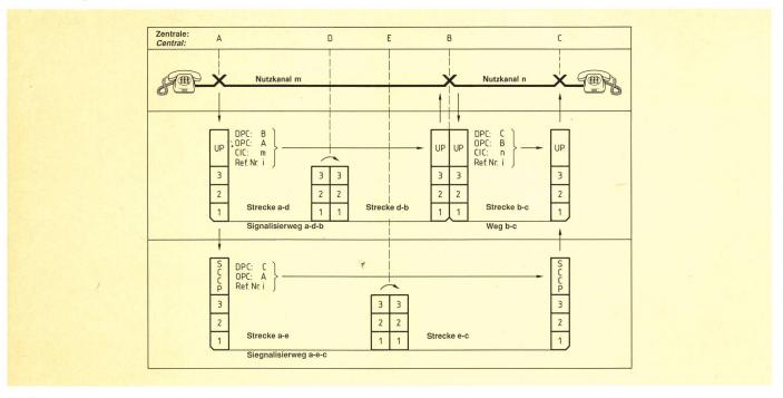
Fig. 5 Signalisierbeziehung für die Vermittlung einer Nutzverbindung von A über B nach C (Netzkonfiguration gemäss Fig. 1, dargestellt für den Meldungsfluss Richtung A - C)
