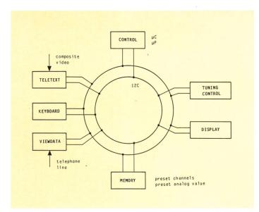
Fig. 1 Der Mikrocontroller mit I<sup>2</sup>C-Bus in einem modernen Fernsehempfänger
