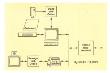
Fig. 2 ISDN-Endgeräte im Büro mit Personalcomputer und Bildtelefon
