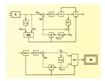
rig. 4 Struktur des Bildcodierers (oben) mit Bewegungskompensation, Blockquantisierung und Interpolation ausgelassener Bilder im Empfänger
