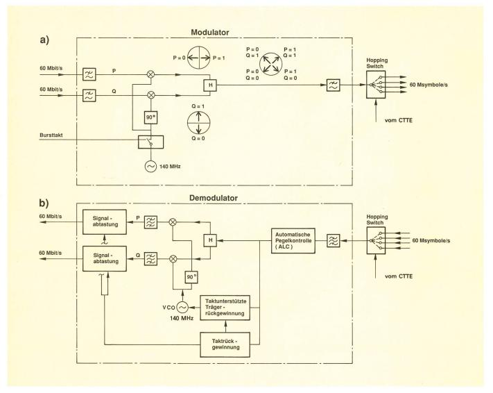
Fig. 13a und 13b Blockschema des 120-Mbit/s-TDMA-Modems inkl. hopping switch
