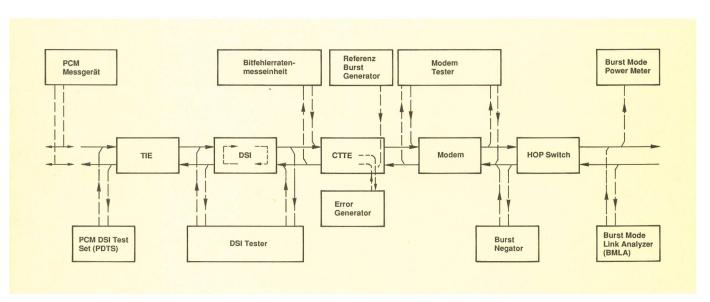
Fig. 16 TDMA/DSI-Testausrüstungen
