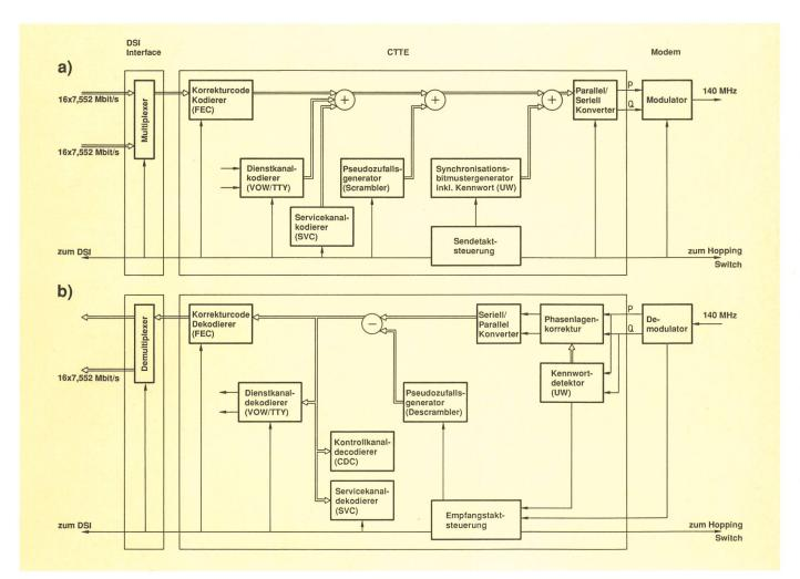
Fig. 12a und 12b Blockschema des CTTE
