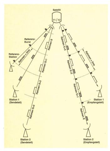
Fig. 4 TDMA-Prinzip
