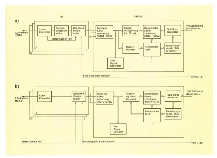
Fig. 10a und 10b Blockschema der TIE/DSI-Ausrüstung
