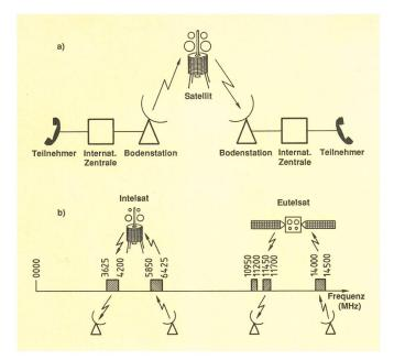
Fig. 1a und 1b Satellitenübertragungskonzept und Frequenzbandbelegung
