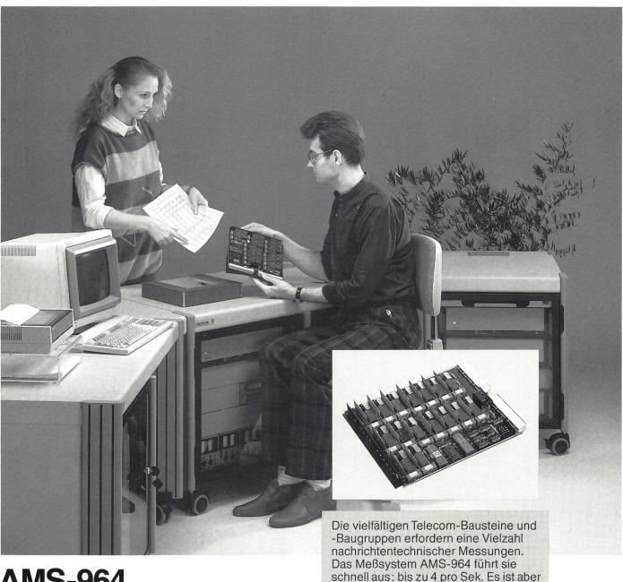
AMS-964 für flexibles Testen von CODECs, COFIs, Line Cards usw. – schnell, genau und kostengünstig
