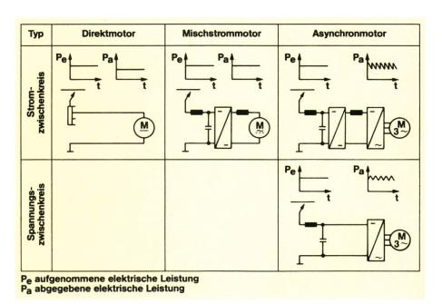
Fig. 1 Antriebstechniken bei Nahverkehrsfahrzeugen
