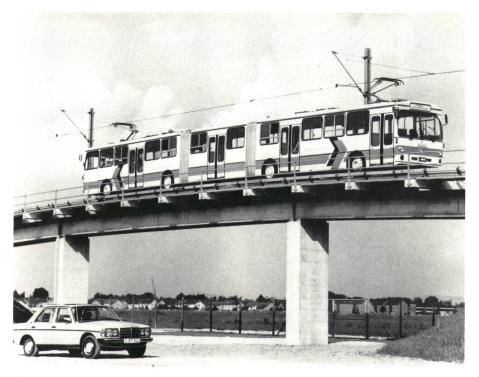
O-Bahn-Fahrzeug (Trolleybus) auf der spurgebundenen eigenen Versuchsstrecke in Rastatt, die auch durch Zusammenkoppeln mehrerer Fahrzeuge die Zugbildung ermöglicht
