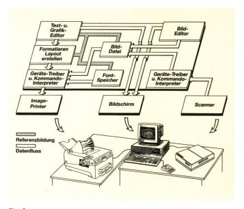
Fig. 9 Schematische Darstellung des Olympia-Systems zur Erstellung von Dokumenten mit beliebigem Informationsinhalt
