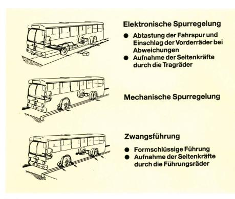
Fig. 3 Spurführungssysteme für lenkbare Strassenfahrzeuge (O-Bahn)
