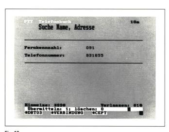
Fig. 12 Sucht der Videotex-Benützer einen Telefonabonnenten, von dem er nur die Nummer kennt, füllt er auf der entsprechenden Datensammlungsseite die beiden Felder aus. Nach dem Übermitteln der Daten bekommt er den gewünschten Telefonbuch-Eintrag
