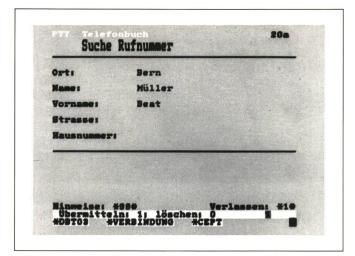
Fig. 7 Um zu den gewünschten Telefonnummern zu kommen, muss der Videotex-Benützer die Felder der Datensammlungsseite ausfüllen
