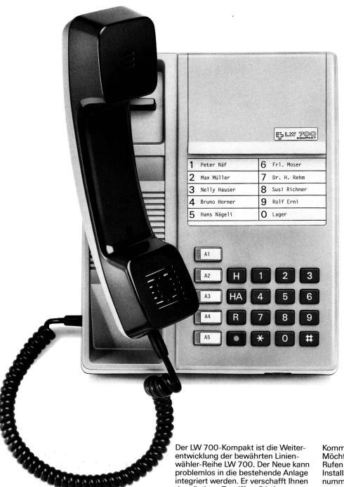
den direkten Zugriff zu 5 Leitungen von jedem LW 700 Apparat aus. Intern kann jeder Mitarbeiter mit jedem direkt kommunizieren.
