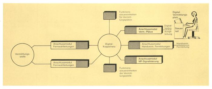
Fig. 1 Struktur der Zentrale für manuelle Dienste
