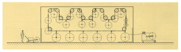
Fig. 1 Schema eines Umlauflagers mit Kabeltrommeln – linke Seite Beladen der Anlage, rechte Seite Auslagerung
