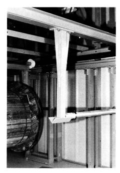
Fig. 4 Lasttraverse mit Auflager für die Tragrohre
