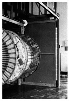
Fig. 5 Vertikales und horizontales Sicherheitslichtgitter
