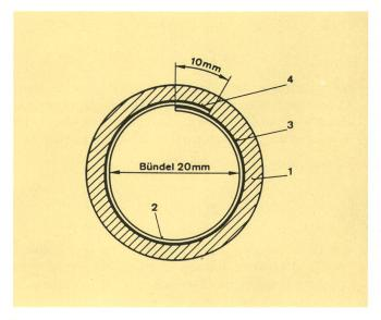
Fig. 1 Section d'un câble à gaine ALT
