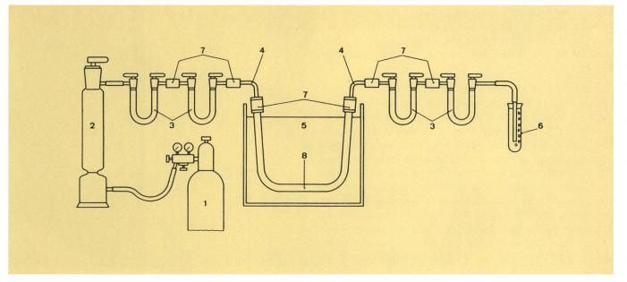
Fig. 2 Dispositif d'essai pour mesure de diffusion gravimétrique
