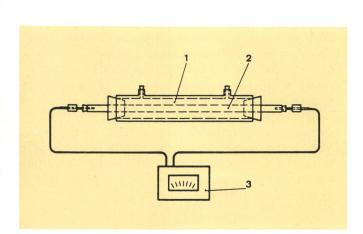
Fig. 3 Dispositif d'essai pour mesure de diffusion par spectrophotométrie à infrarouge
