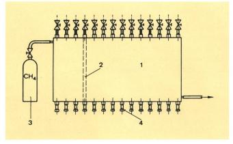
Fig. 5 Dispositif d'essai pour mesure de la diffusion par chromatographie à phase gazeuse
