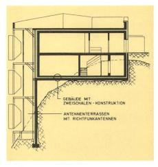
Fig. 3 Schnitt durch Gebäude und Antennenter-
