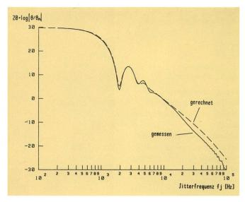
Fig. 16 Jitterakkumulation einer Kettenschaltung von 30 Regeneratoren  $\Theta$  Jitter eines einzelnen Regenerators  $\Theta_n$  Jitter von n Regeneratoren
