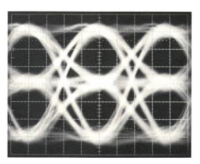
Fig. 4 Augendiagramm am Entscheidereingang 25 dB Kabeldämpfung bei 12 888 kHz
