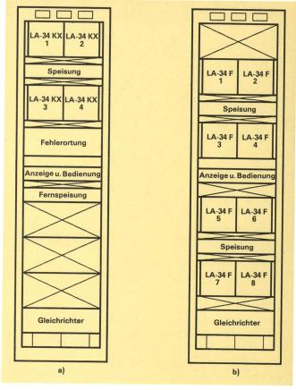
Fig. 13 Leitungsabschlussgestelle a) mit 4 LA-34-KX-Ausrüstungen
