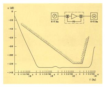
Fig. 6 Gemessene Umlaufdämpfung eines Regenerators
