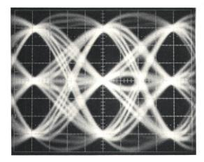
Fig. 5 Augendiagramm am Entscheidereingang 75 dB Kabeldämpfung bei 12 888 kHz
