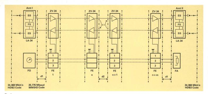
Fig. 1 34-Mbit/s-Koaxialkabel-Streckenaufbau
