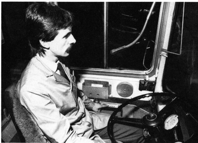
Fig. 10 Einbau der Sprechfunkanlage im Postauto
