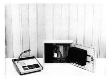
Fig. 4 Bedienanlage PA 1700 für Regionalstationen
