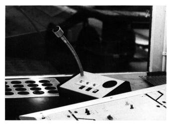
Fig. 5 Bedienanlage PA 101-1 für Bahnhöfe
