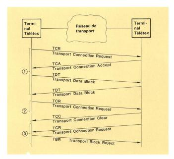
Fig. 6 Phases de déroulement du protocole de transport
