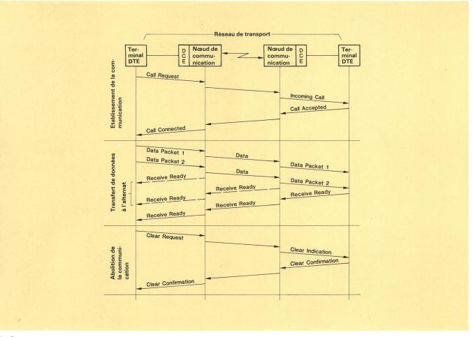
Fig. 5 Phases de déroulement du protocole de commutation - ETTD Equipement terminal de traitement de données
