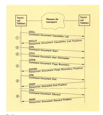
Fig. 9 Phases de déroulement de la commande de documents
