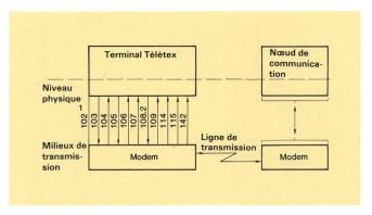
Fig. 3 Couche de transmission des bits
