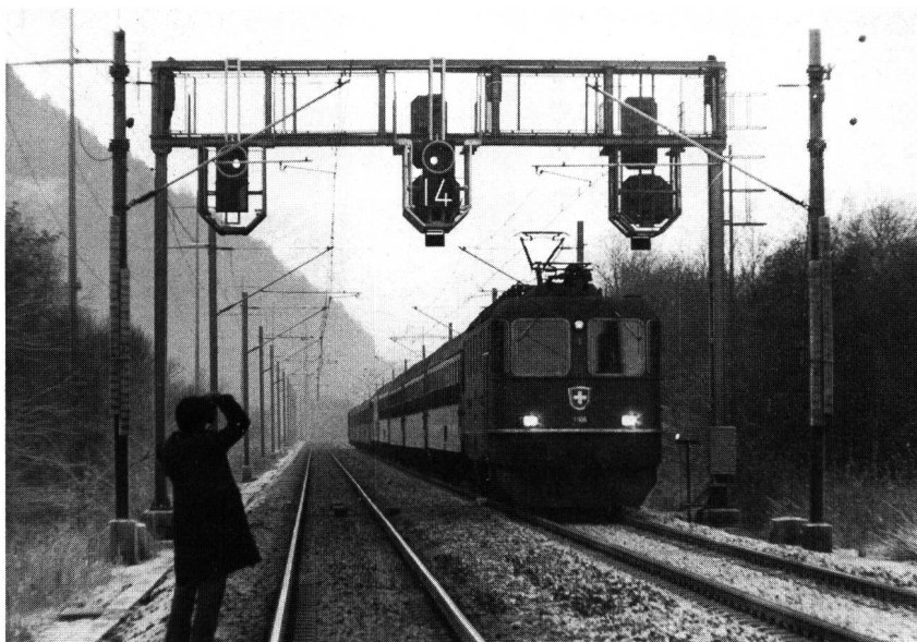
Fig. 1 Signale des neuen Systems auf der Strecke Leuk-Visp, die mit 160 km/h zu fahren erlauben
