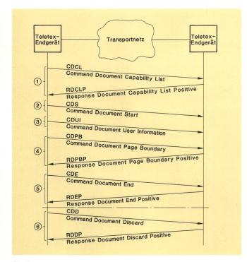
Fig. 9 Ablaufphasen der Dokumentensteuerung
