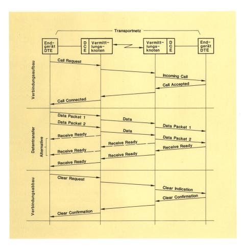
Fig. 5 Ablaufphasen des Vermittlungsprotokolls DTE-Endgerät DCE-Vermittlungsknoten
