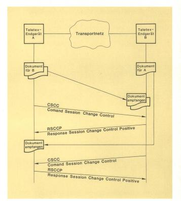
Fig. 8 Richtungsumkehr
