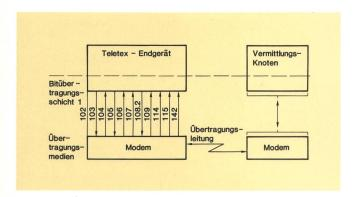
Fig. 3 Bitübertragungsschicht
