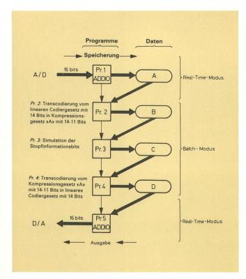
Fig. 11 Software-Simulation
