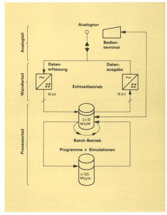
Fig. 10 Prinzipieller Laufweg der digitalen Signale
