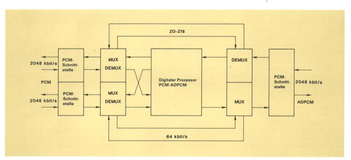
Fig. 5 Schema des Transcoders PCM-ADPCM mit 60 Kanälen
