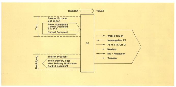
Fig. 6 Prozedur Teletex nach Telex CF Umsetzer
