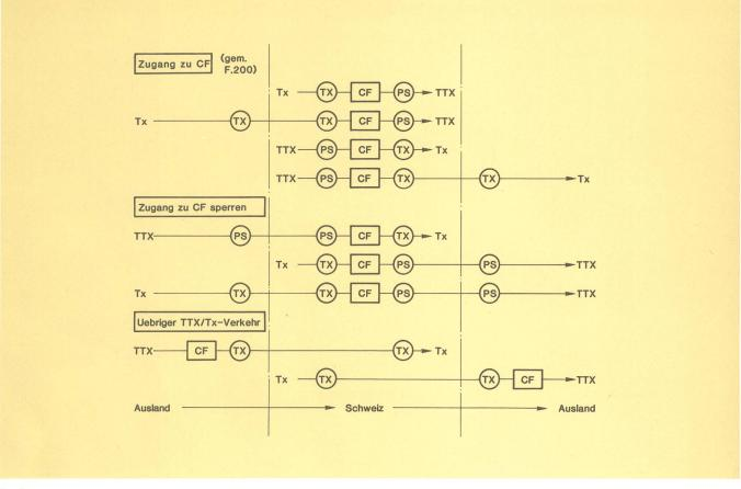
Fig. 1 Verkehrsfluss über den Umsetzer
