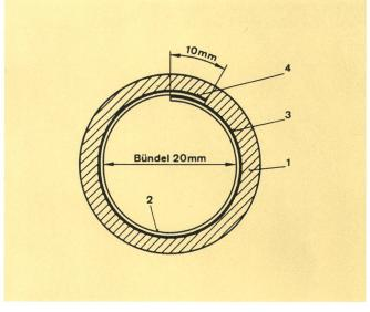
Fig. 1 Querschnitt durch ALT-Kabelmantel 1 Polyäthylen-Kabelmantel
