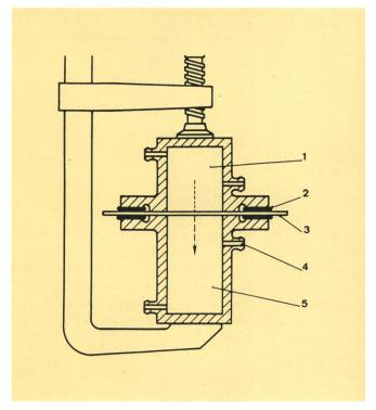
Fig. 4 Messkammer für Diffusionsmessung an Folien
