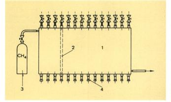
Fig. 5 Versuchsanordnung für gaschromatographische Diffusionsmessung
