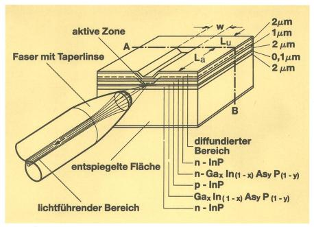
Fig. 7 Lumineszenzdioden-Sender mit angekoppelter Monomodefaser, wie sie für den Teilnehmeranschluss vorgeschlagen wird
