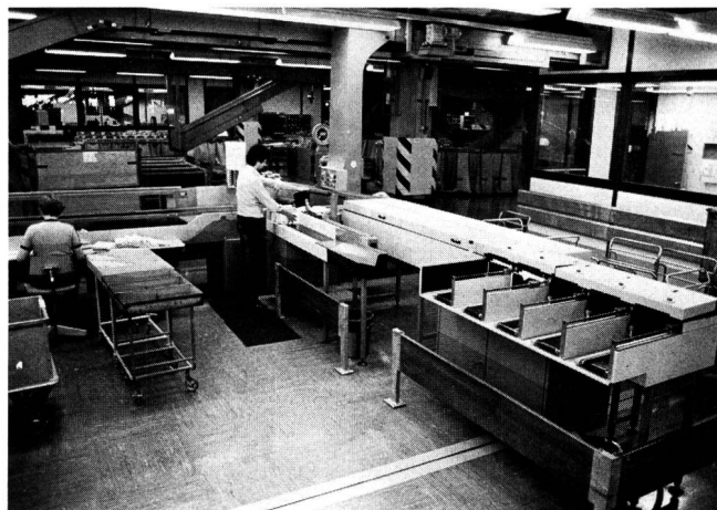
Fig. 11 Teilmechanische Briefaufbereitungsanlage. Automatische Aufstell- und Stempelmaschine mit fünf Stapelfächern
