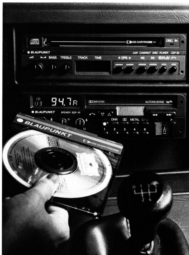
Fig. 5 Nun kann die Compact Disc auch im Auto eingesetzt werden. Um ihr Einführen in den Spieler zu erleichtern und die CD zu schonen, wird eine besondere Hülle entwickelt, aus der sie bei Autoradios nicht entfernt zu werden braucht
