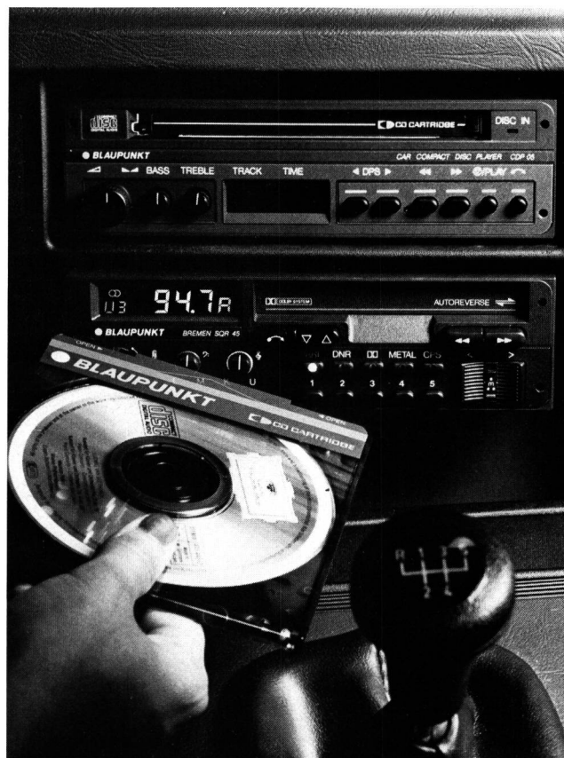
Fig. 5 Nun kann die Compact Disc auch im Auto eingesetzt werden. Um ihr Einführen in den Spieler zu erleichtern und die CD zu schonen, wird eine besondere Hülle entwickelt, aus der sie bei Autoanlagen nicht entfernt zu werden braucht
