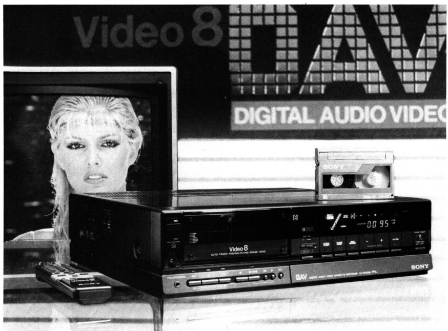
Fig. 3 Kombiniertes Digital-Audio- und Videorecorder im Video-8-Format für wahlweise TV-Aufnahme mit dem normalen Fernsehton, TV-Aufnahme mit zusätzlichem Stereoton (als PCM-Aufzeichnung) oder Tonaufnahme digital in 6 Spuren zu je maximal 3 Stunden
