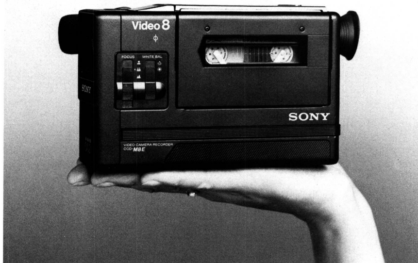
Fig. 4 Nur handflächengross und 1 kg leicht ist dieser Kamerarecorder des neuen Systems Video 8. Die Kamera benutzt ein CCD-Chip mit 290 000 Pixels anstelle einer Bildröhre. Die im integrierten Videorecorder verwendete Kassette ist kaum grösser als die bekannte Compact Cassette
