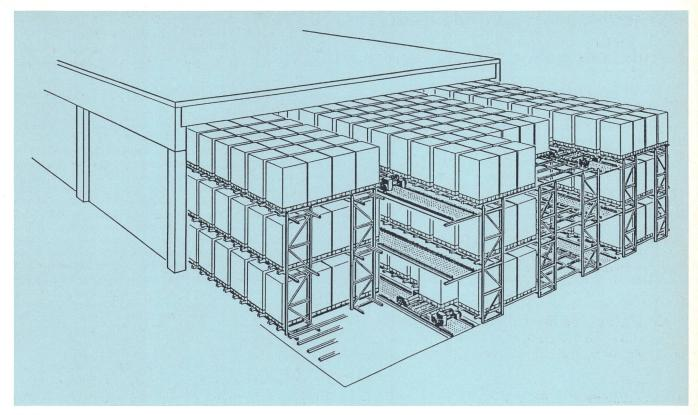
Fig. 2 Schema des «dynamischen Blocklagers»
