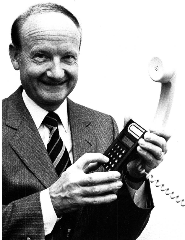
Fig. 2 Mit dem Ubitel-Zusatzgerät lassen sich über das Telefon Informationen über das Konto des betreffenden Kunden diskret und sicher abfragen. Die Informationsausgabe geschieht in gesprochener Form
