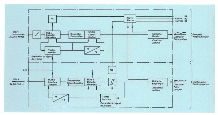
Fig. 1 Blockschema der 34-Mbit/s-Glasfaserendausrüstung
