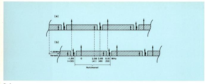
Fig. 2 Kanalraster a) CCIR-Standardraster für den Bereich III, Norm B
