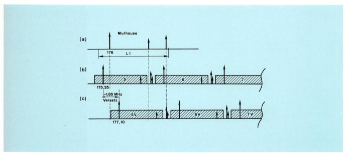
Fig. 3 Störungen des Kanals  $L_1$  (a) im CCIR-Norm-B-Raster (b) und im versetzten Kabelkanalraster (c)
