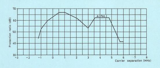
Fig. 1 Schutzabstände für die Sichtbarkeitsgrenze beim PAL-Signal
