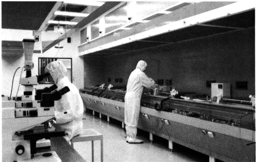
Fig. 6 Blick in einen Teil der Fabrikation in Oudenaarde. In diesen Räumen herrscht eine Staubfreiheit der Luft, wie sie selbst in Operationssälen kaum anzutreffen ist
