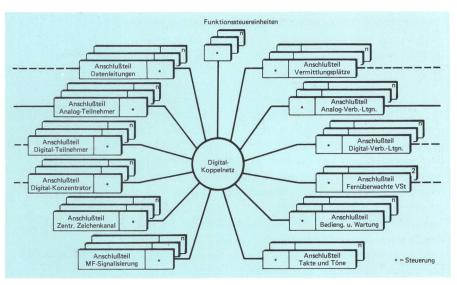
Fig. 1 Struktur des Systems 12
