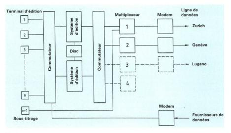
Fig. 1 Schéma de base du système d'édition du télétexte à Bienne
