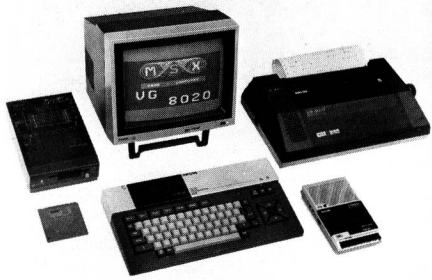
Der MSX-Homecomputer VG 8020 mit 80 Kbit Speicherkapazität umgeben von den von Anfang an verfügbaren Peripheriegeräten
