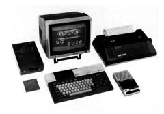
Der MSX-Homecomputer VG 8020 mit 80 Kbit Speicherkapazität umgeben von den von Anfang an verfügbaren Peripheriegeräten
