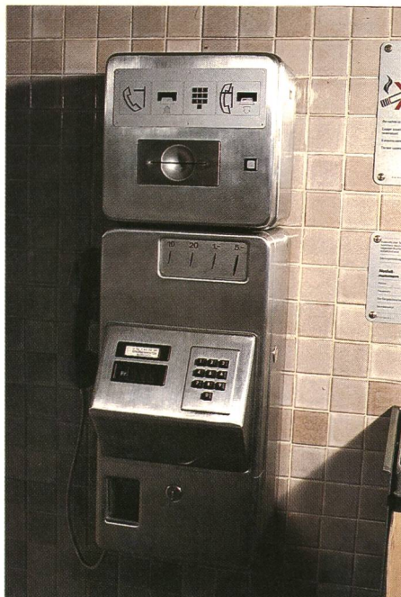
Fig. 7 Kabine mit Münztelefonapparat und Kartenleser für bargeldloses Telefonieren – Cabine avec appareil de téléphone à prépaiement et lecteur de carte permettant de téléphoner sans numéraire – Cabina con apparecchio a prepagamento con lettore di schede per telefonare senza moneta
