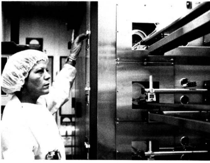
In solchen Öfen werden die Scheiben zur Herstellung integrierter Schaltungen dotiert
