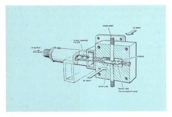
Fig. 9 Hohlleitermischer für 40 GHz...60 GHz
