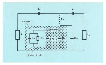
Fig. 5 Ersatzschaltbild des Gunn-Oszillators
