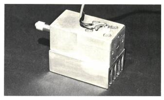
Fig. 13 40-GHz...60-GHz-Oszillator auf Kühlkörper
