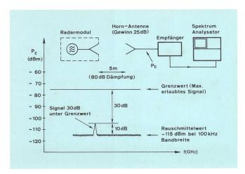
Fig. 1 Pegelverhältnisse bei Typenprüfungen
