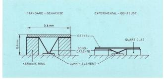
Fig. 6 Vergleich des Standard- und Experimentalgehäuses
