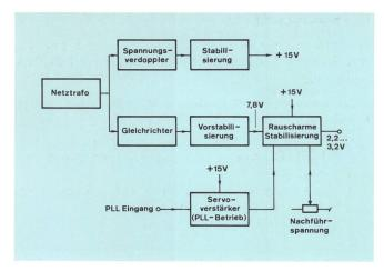
Fig. 11 Blockschaltbild der rauscharmen Speisung für den Oszillator
