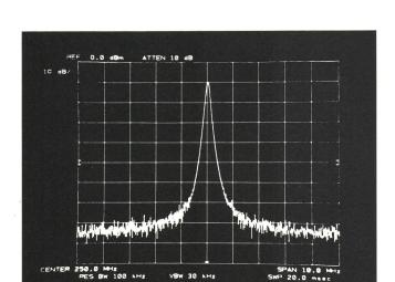
Fig. 8a Spektrum des Gunn-Oszillators bei 50 GHz mit einer Auflösung von 1 MHz/Div. dargestellt
