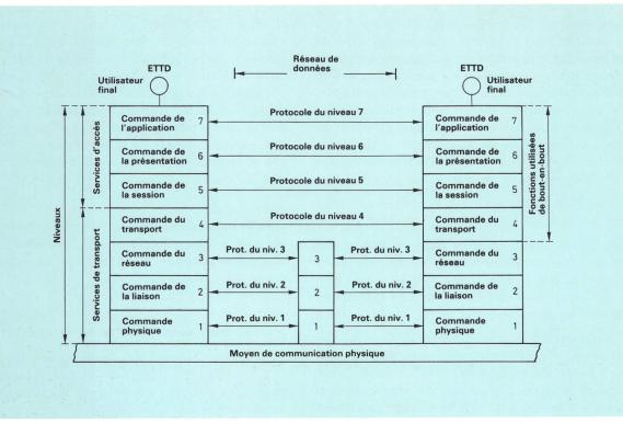
Modèle d'architecture OSI de l'ISO - Modello di architettura OSI dell'ISO Commande de la session - Sessione
