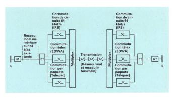
Fig. 3 RNIS: Possibilité de réalisation à moyen terme – Possibilità di realizzazione in tempi medi
