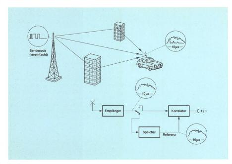
Fig. 3 Auflösung der Mehrwegeübertragung
