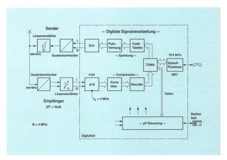
Fig. 6 Blockschaltbild des Mobilfunkgerätes
