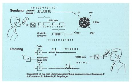
Fig. 2 Prinzipielle Funktionsweise der Funkübertragung bei CD 900
