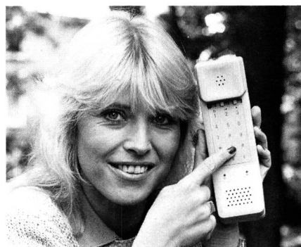
Fig. 8 Das in einem Handapparat integrierte mobile Funktelefon
