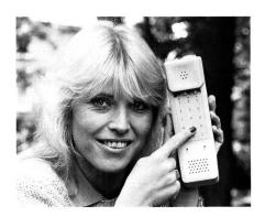
Das in einem Handapparat integrierte mobile Funktelefon
