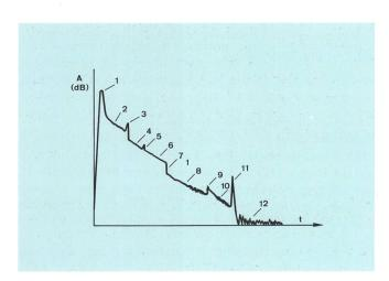
Fig. 4 Typische Rückstreu-Dämpfungskurve einer Faser
