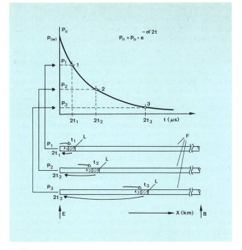
Fig. 3 Rückstreusignal in einer idealen Faser B Faserende F Glasfaser
