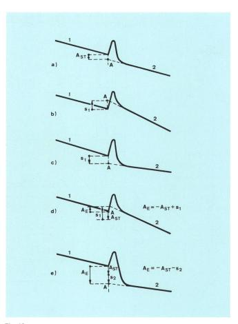
Fig. 10 Mögliche Rückstreuverläufe in einem optischen Stecker
