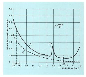
Fig. 6 Spektrale Dämpfung einer Glasfaser
