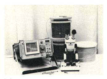
Fig. 7 Rückstreu-Dämpfungsmessplatz
