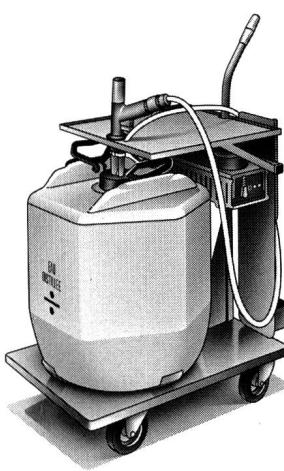
**Batterie-Füllgerät (Aqua-Jet)** für den Unterhalt von Traktions- und Stationären Batterien. Leicht manövrierbar, netzunabhängiger Füllwagen, dessen Einfüllpistole bei Erreichen des korrekten Säure-Füllstandes automatisch abstellt. Mit eingebautem Auflade-Automaten.
