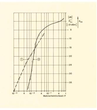
Fig. 15 Prognostizierte und gemessene Wahrscheinlichkeit für die Dämpfung infolge Niederschlags auf der Strecke Generoso–Jungfraujoch
