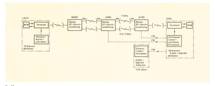
Blockschema der Verbindung mit den Überwachungseinrichtungen BFM Bitfehlermessplatz Raumdiversity
