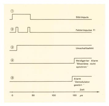
Fig. 10 Zeitlicher Ablauf der Auswirkungen einer impulsförmigen Störung
