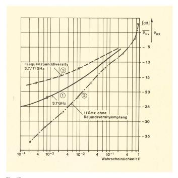
Fig. 17 Gemessene Wahrscheinlichkeit für die Dämpfung infolge von Mehrwegausbreitung auf der Strecke Generoso-Jungfraujoch
