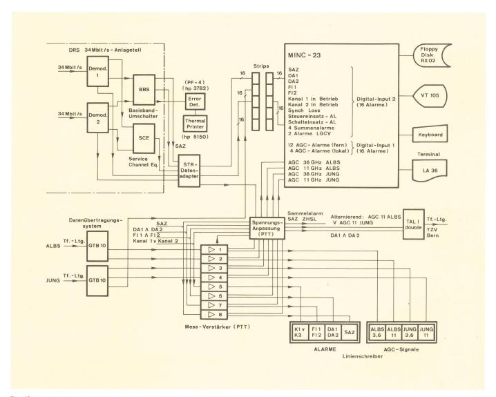
Fig. 13 Blockschema der Überwachungseinrichtung im Terminal Zürich-Selnau
