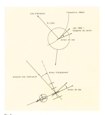
Fig. I Erreur d'alignement de l'antenne de réception pour un vol circulaire
