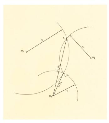
Fig. 2 Localisation avec télémètre-radar
