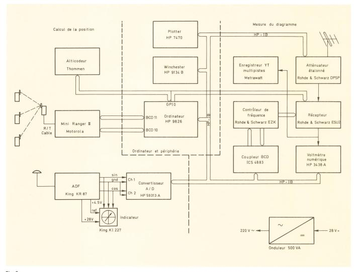
Fig. 3 Equipement de mesure automatique de 30 à 1000 MHz
