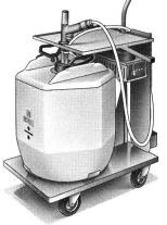
Batterie-Füllgerät (Aqua-Jet) für den Unterhalt von Traktions- und Stationär-Batterien. Leicht manövrierbar, netzunabhängiger Füllwagen, dessen Einfüllpistole bei Erreichen des korrekten Säure-Füllstandes automatisch abstellt. Mit eingebautem Auflade-Automaten.
