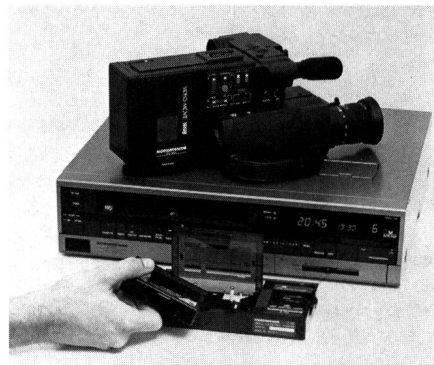
Fig. 7 Kamerarecorder mit der kleinen VHS-C-Kassette, die, in einen Adapter eingesetzt, auf jedem normalen VHS-Recorder abgespielt werden kann.
