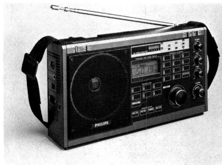
Fig. 11 Welt-Empfänger auf Doppelsuperbasis, mit von 146 kHz bis 30 MHz durchstimmbarem PLL-Quarz-Tuner, für CW- und SSB-Empfang, LCD-Frequenzanzeige und vielen weiteren empfangsfreundlichen Details
