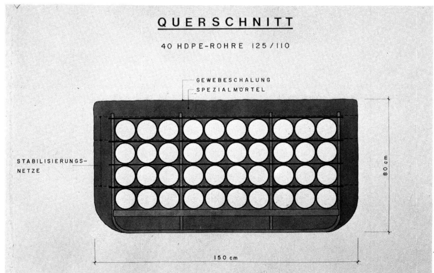
Fig. 3 Kunststoffrohrblock-Querschnitt in der Limmat
