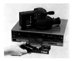
Kamerarecoder mit der kleinen VHS-C-Kassette, die, in einen Adapter eingesetzt, auf jedem normalen VHS-Recorder abgespielt werden kann.
