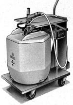
Batterie-Füllgerät (Aqua-Jet) für den Unterhalt von Traktions- und Stationär-Batterien. Leicht manövrierbar, netzunabhängiger Füllwagen, dessen Einfüllpistole bei Erreichen des korrekten Säure-Füllstandes automatisch abstellt. Mit eingebautem Auflade-Automaten.
