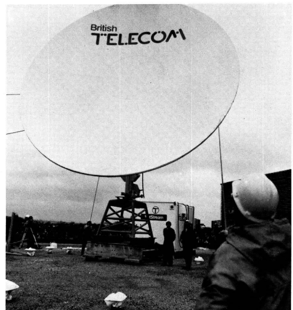
Fig. 1 Die kleine SatStream-Antenne für Satelliten-Bodenstationen wird in Grossbritannien bald ein alltäglicher Anblick auf den Dächern von Bürogebäuden multinationaler oder Grossunternehmen sein
