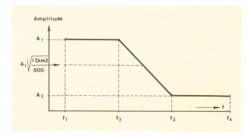
Fig. 7 Amplitude de la gigue à la sortie des équipements de ligne du réseau interurbain. Les valeurs des paramètres A1, A2, f1, f2, f3, f4 sont identiques à celles indiquées dans le tableau VI
