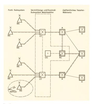
Fig. 17 Netzaufbau des Mobiltelefonsystems
