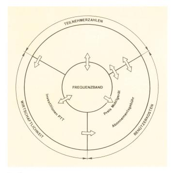
Fig. 10 Wechselbeziehungen beim Bestimmen des Frequenzbandes
