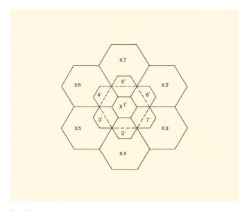
Bildung von Kleinzellen zur Erhöhung der Kanalzahl
