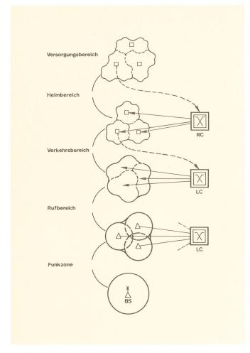
Fig. 18 Wechselbeziehungen im Netz des Mobiltelefonsystems
