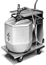
Batterie-Füllgerät (Aqua-Jet) für den Unterhalt von Traktions- und Stationär-Batterien. Leicht manövrierbar, netzunab- nängiger Füllwagen, dessen Einfüllpistole bei Erreichen des korrekten Säure-Füllstandes automatisch abstellt. Mit eingebautem Auflade-Automaten.
