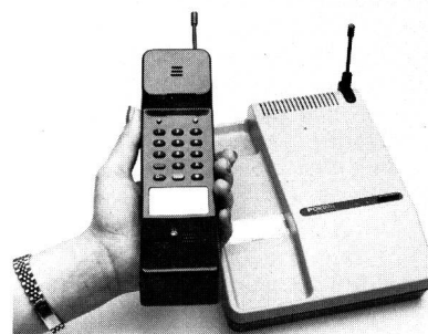
Fig. 3 Mit dem Portatel von Autophon kann man sich bis zu 200 m von der Basisstation entfernt frei bewegen
