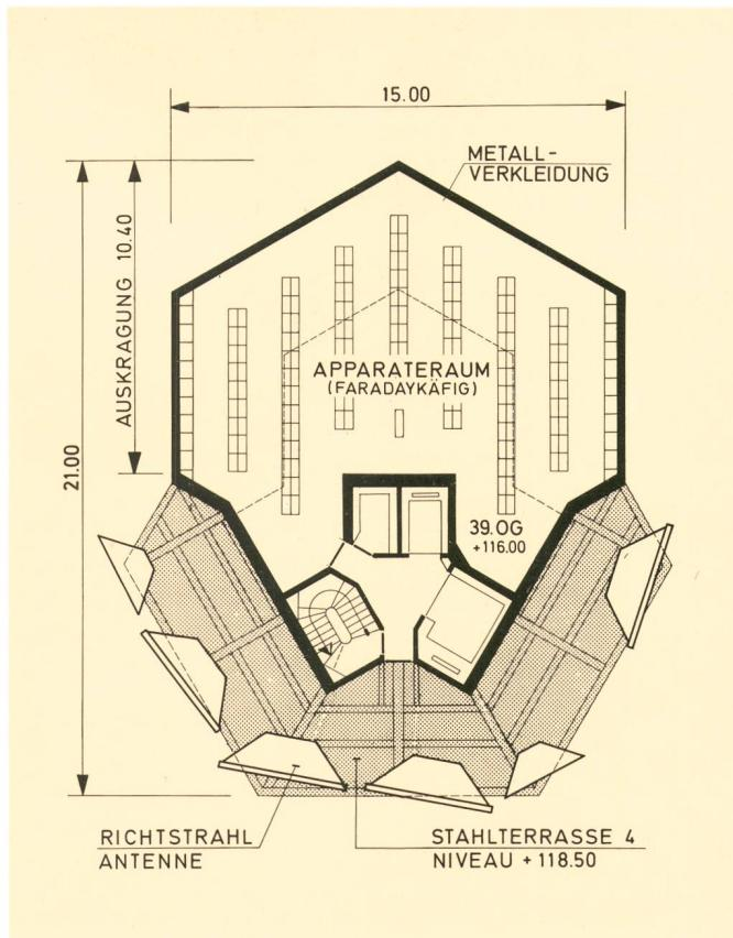
Querschnitt in Höhe 116 m, mit Apparateraum und Stahlterrassen – Plan de l'étage à la cote 116 m, avec le local des appareils et les terrasses d'antennes
