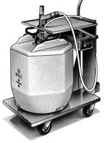
Batterie-Füllgerät (Aqua-Jet) für den Unterhalt von Traktions- und Stationär-Batterien. Leicht manövrierbar, netzunabnängiger Füllwagen, dessen Einfüllpistole bei Erreichen des korrekten Säure-Füllstandes automatisch abstellt. Mit eingebautem Auflade-Automaten.
