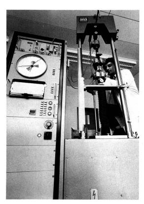
Einrichtung zur Dehnungs- und Zugprüfung
