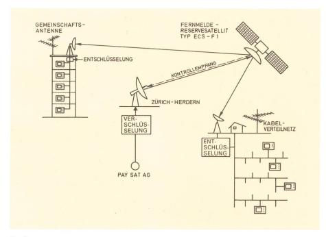
Fig. 3 Prinzip der Übertragung des Pay-TV via Satellit
